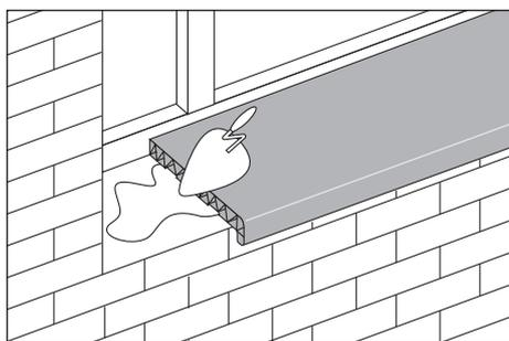
металлического профиля. Рекомендуется оставлять расстояние не менее 100 мм между подоконником и внешним краем батареи отопления.
